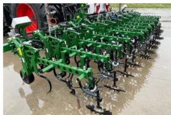
Bineuse à guidage optique (caméras)
